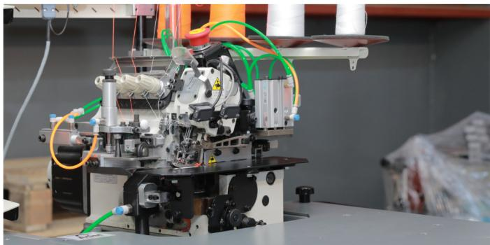
Kot pantolonda sağ ve sol iki panelin birlikte aynı zamanda üstten alta sürfle dikişine imkan sağlayan özel tasarım.
