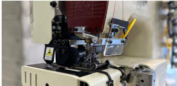
Dünyanın ilk ve tek Hybrid Kemer Otomati.Takım ve aparat değiştirmek suretiyle hem standart düz ve kavisli tip kemer ,hem de LEVI'S tipi kemer takabilme imkanı aynı makinede bir arada.
